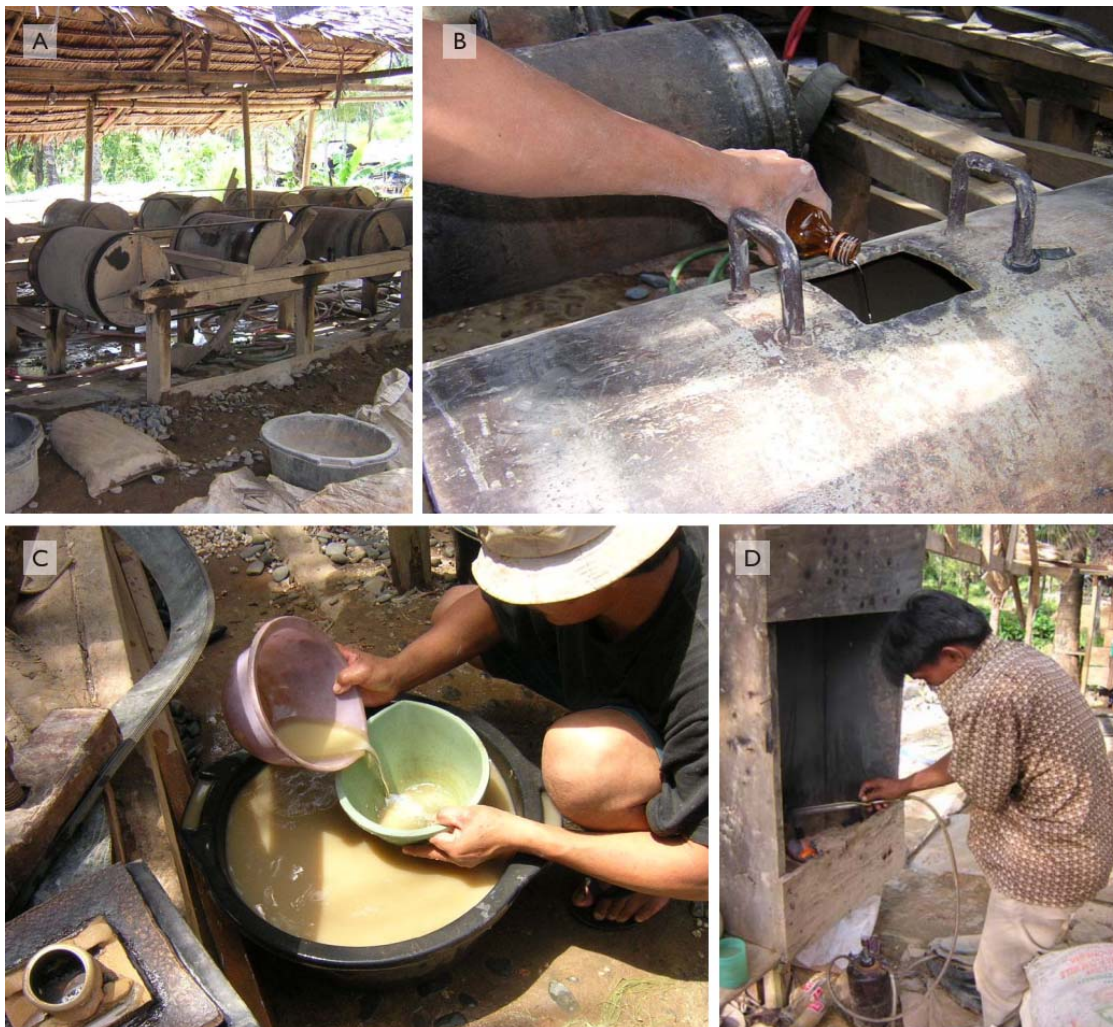
Procesamiento de mineral de oro utilizando mercurio en Talawaan, Indonesia.
