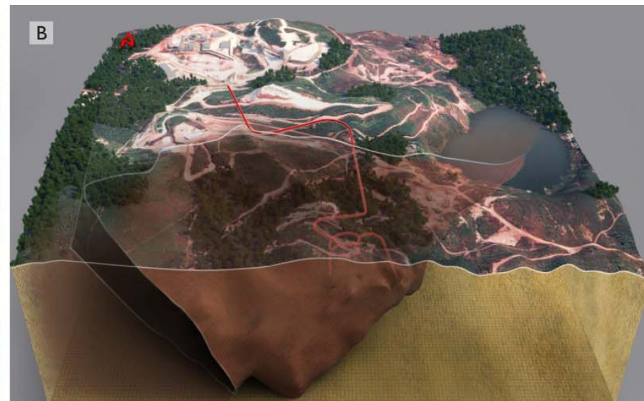
Serra Pelada, Brasil. A: Foto de época (1980) de la explotación informal por parte de miles de garimpeiros. B: Extensión de la mineralización en profundidad y desarrollo de los trabajos para su explotación mecanizada (extraído de Colossus Minerals Inc.). En el sector derecho se observa el lago formado por la inundación del open pit creado por los garimpeiros.
